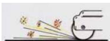
mechanicky vznikající jiskry
